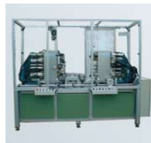
23 têtes de pose pour assembler un châssis d'ordinateur
