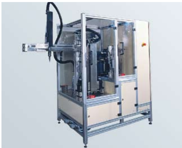
10 têtes de pose pour assembler des bandes d'étanchéité pour l'automobile
