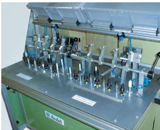
10 têtes de pose pour assembler des bandes d'étanchéité pour l'automobile
