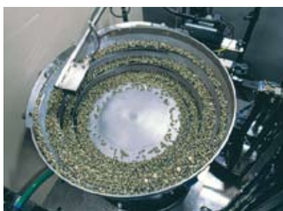
Rivets alimentés par bol vibrant
